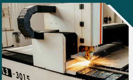
Станок лазерной резки 4x12 м ЧПУ
